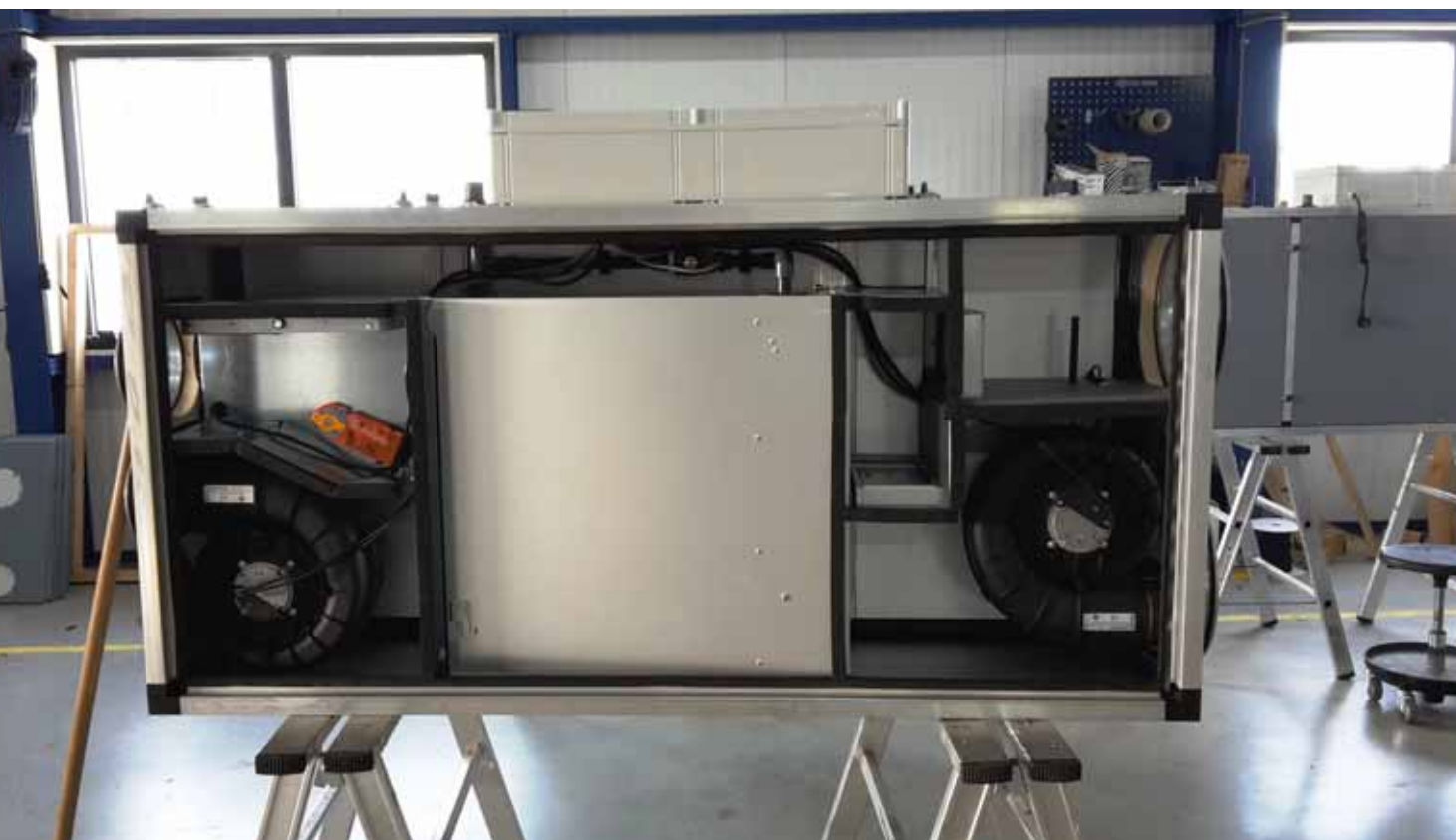
Bovenaanzicht van de ICU-plafonduin tijdens de productie.
